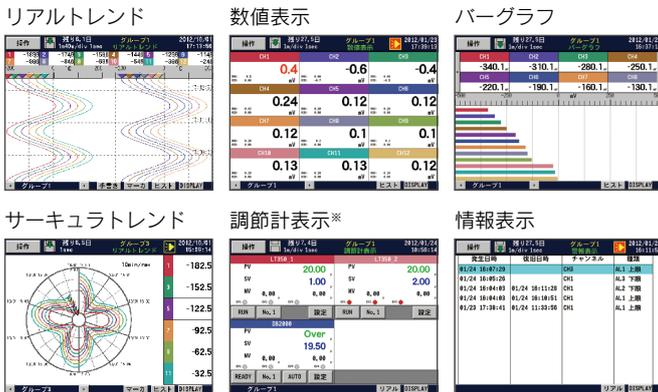
※下位通信でチノー調節計を接続時に、PV、SV、MVを表示
