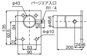
●専用前面水冷板IR-ZZWC (ハード形保護ケース専用)
