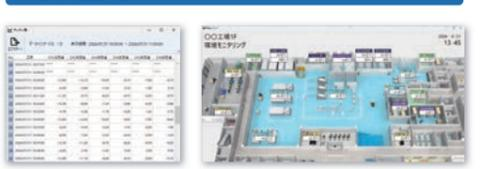
CISAS 5(シーザス ファイブ)は施設内に分散した装置・設備のデータを1ヶ所に集約し、監視・分析・エビデンス管理ができるパッケージソフトです。集録したデータはトレンドグラフ表示、グラフィック表示、日報・週報・月報出力が可能です。
